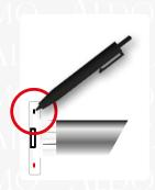
Drücken Sie den Setup Knopf (P1) solange bis der Motor eine kurze Bewegung ausübt.
