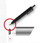
Drücken Sie den Setup Knopf (P1) solange bis der Motor 3x eine kurze Bewegung ausübt.
