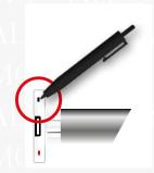
Drücken und halten Sie den Setup Knopf (P1) solange bis der Motor 2x eine kurze Bewegung ausgeübt hat.
