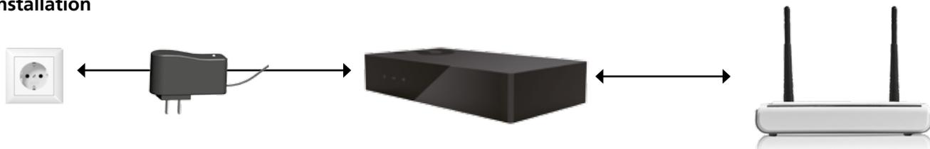
Nach dem Sie die Smart Box an einem geeigneten Platz aufgestellt haben, Netzteil einstecken und die Smart Box und Router mit dem Netzkabel RJ45 verbinden.
